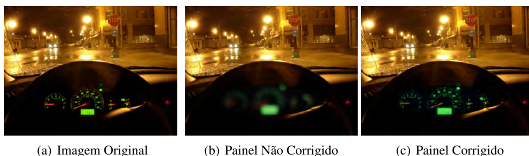
Figura A.5: Diferença na visão de um indivíduo com presbiopia ao dirigir usando um painel regular (b) e com um monitor personalizado para suas deficiências visuais (c). A imagem (a) mostra como um emmetrope veria o mesmo painel.
