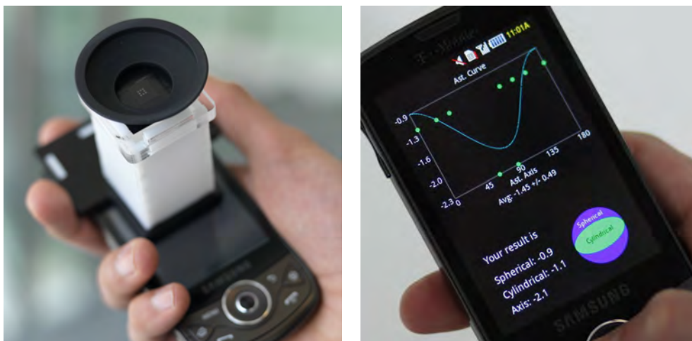
Figura A.2: Esta tese propõe dois novos métodos subjetivos centrada no paciente para medir parâmetros ópticos do olho humano. Neste protótipo, o acessório para celular (esquerda) cria um campo luz limitado, projetado para medição de erros refrativos em termos de valor esférico, cilíndrico e eixo de astigmatismo (direita). Foto por Jonathan Williams.
