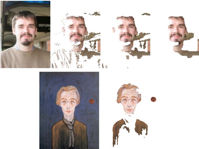
Figura 1.19.: Segmentação de imagens com diferentes penalidades p . Acima: (a) Imagem original (b) Segmentação somente com probabilidades ( p = 0 ) (c) p = 1000 (d) p = 10000 . Abaixo: (a) Walter Gramatté, Selbstbildnis mit rotem Mond, 1926 (b) Segmentação com p = 10000 . A probabilidade de um pixel representar pele foi determinado conforme Jones e Rehg (1998).
