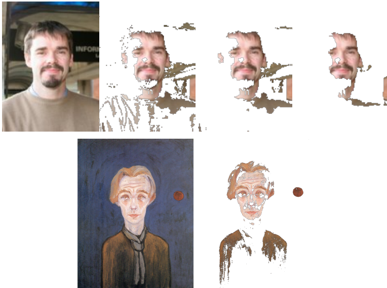
Figura 1.7: Segmentação de imagens com diferentes penalidades p . Acima: (a) Imagem original (b) Segmentação somente com probabilidades ( p = 0 ) (c) p = 1000 (d) p = 10000 . Abaixo: (a) Walter Gramatté, Selbstbildnis mit rotem Mond, 1926 (b) Segmentação com p = 5000 . A probabilidade de um pixel representar pele foi determinado conforme Jones and Rehg (1998) .
