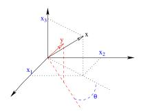
Exemplo em N=3 dimensões. O operador é uma rotação de ângulo  $\theta$ , o eixo é  $(Ox_3)$ . Obtém-se
