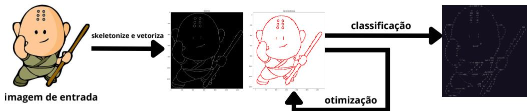
**Figura 1. Workflow do método**
